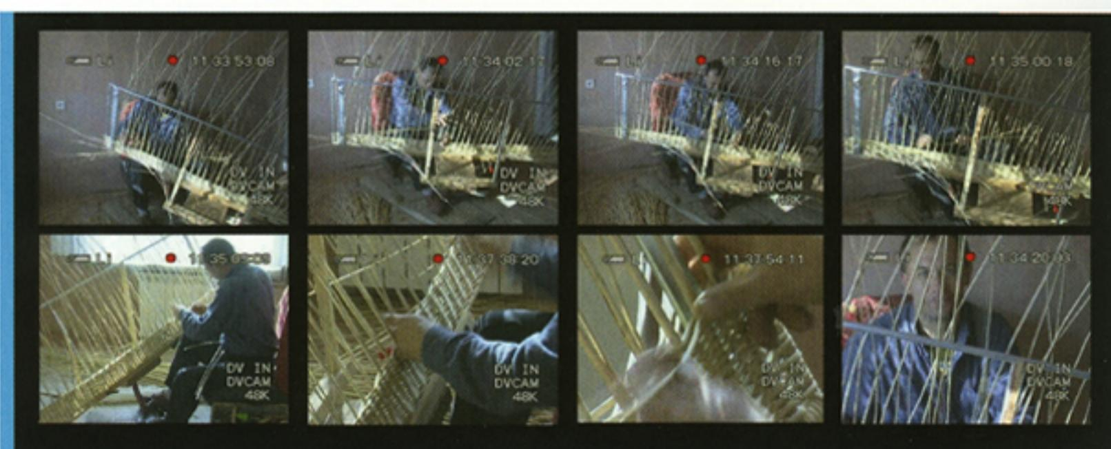
Proces ręcznej produkcji modułarnych elementów wiklinowej struktury elewacji polskiego pawilonu EXPO 2005 w Aichi w Japonii | Process of manufacturing of modular ???? for the elevation of the Polish Pavilion EXPO 2005, Aichi, Japan
